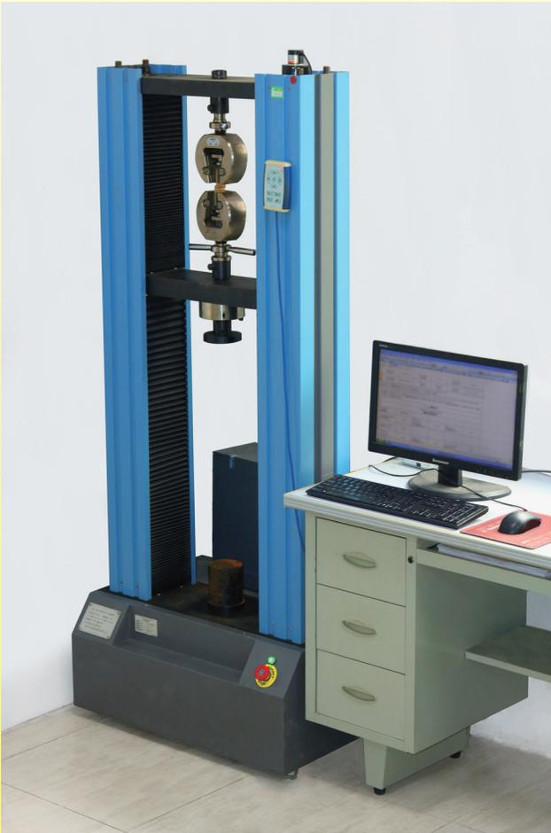
Equipo de resistencia a la tracción y elongación en la rotura
